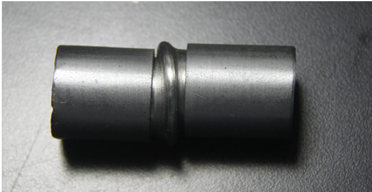
**双金属复合钢管：**是将镀锌钢管或焊管、无缝钢管和壁厚更薄的不锈钢管强力嵌合在一起的新型复合给水管材，也是一种更理想的管道升级换代产品。它保留了两种不同材料内在的优点，互补了它们内在的不足，并且沿用了镀锌钢管传统成熟的安装方式和工艺，因此在使用中方便、可靠、卫生、安全。根据基管与内衬管选材的不同，以及制造工艺的提升，已有不少厂家生产的双金属复合管广泛应用于油田、化工、电力等工业领域，其适用范围越来越\*\*\*，带来的经济、环境、社会效益也更加明显。
