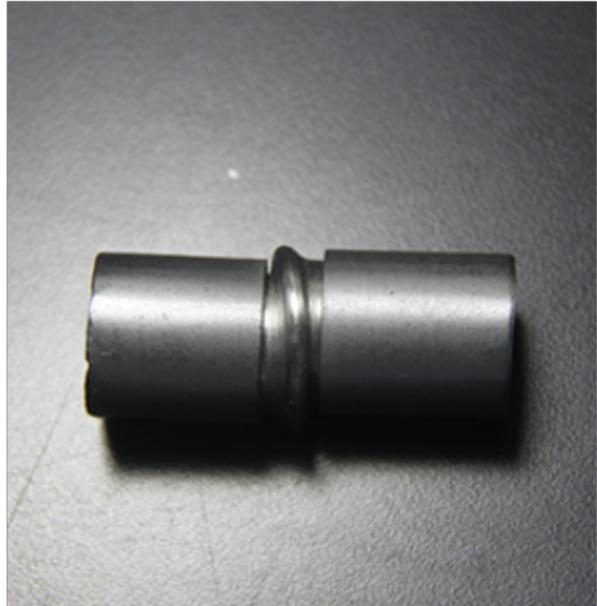
采用压熔锚合双金属冶金复合技术外基管材质20G无缝管内覆管材质T2紫铜管彻底解决了普通双金属复合管存在的层间结合力低的问题。外基管壁厚作为管道的承压层，保证承压安全；内覆管壁厚作为管道的功能层，使基管更耐腐蚀。特点一：结合强度140MPa以上，真正的复合如一铜复合换热管，外层使用耐压金属管道，内层使用T2紫铜无缝钢管，经过特殊加工工艺，将两者结合为一体，既能防止腐蚀，又耐受高温；结合强度为传统铜复合管的6倍，高达140MPa以上，彻底解决了传统铜复合管层间结合力差的世纪难题。特点二：优异的机械加工性能铜复合换热管，具有优异的整体机械性能，强度高，韧性好。特点三：优良的抗疲劳能力由于产品内外层两种材料都是金属，所以耐高温，而且两者的热胀冷缩性能系数接近，因而在温度变化较大的情况下，也能保证管道中间结合层不会被破坏；经过常温到500℃高温循环试验验证，管道完好无损。特点四：出色的防腐蚀能力铜复合换热管，具有出色的防腐蚀能力。良好的抗缝隙腐蚀、点腐蚀、应力腐蚀破裂能力。内覆管壁厚作为管道的功能层，使基管更耐腐蚀。天津工业级双金属冶金复合钢管报价
